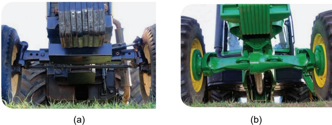
Figura 4 – Diferentes processos de fabricação predominantes (a) caldeiraria e (b) fundição [2]
